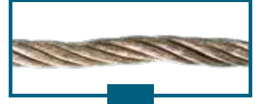
Halat çapındaki bölgesel düşme Local reduction in rope diameter
