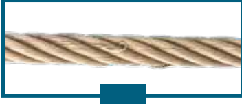
Tel Çıkması Wire protrusion
