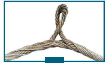
Dönmez tip halatlarda öz püskürmesi Protrusion of inner rope of rotation-resistant rope
