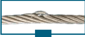
Damar bükülmesi yada dışarı çıkması Strand protrusion or distortion
